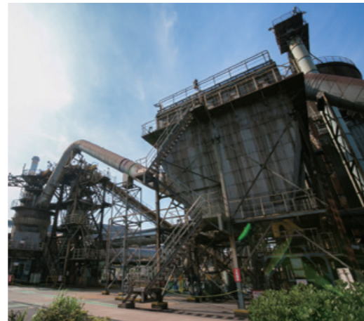
▲ローラーミルで水砕スラグの粒度を細かくし、微粉末の状態に加工する。
