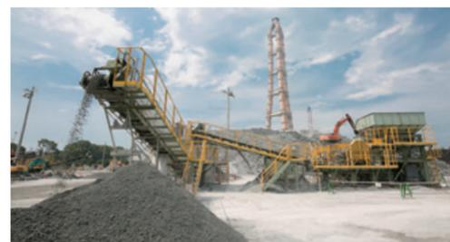
▲高炉から出た徐冷スラグを破碎し、粒度を細かくして路盤材などへ製品化していく。
